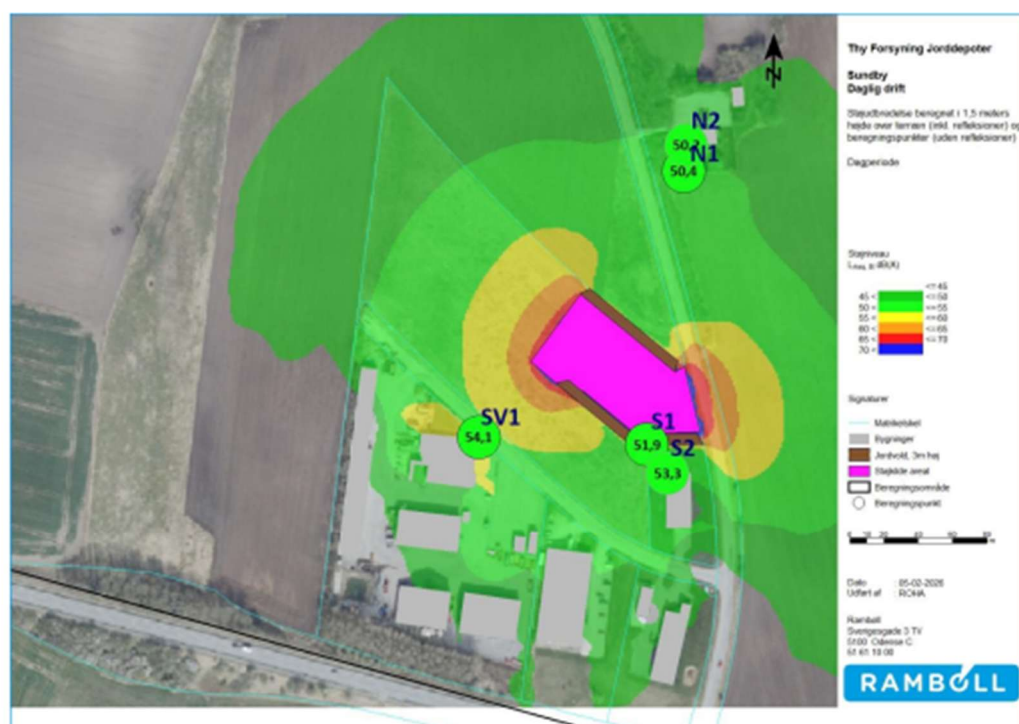
Figur 7-1 Daglig drift på projektområdet, inklusiv 3m høj jordvold. Støj beregnet i udvalgte beregningspunkter og som støjdbredelse i hele området. Uden evt. +5 dB tillæg.
